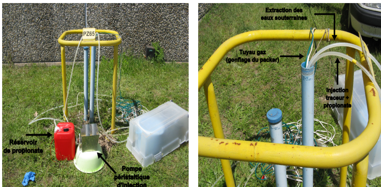
FIGURE 10.3 – Dispositifs utilisés sur le terrain
