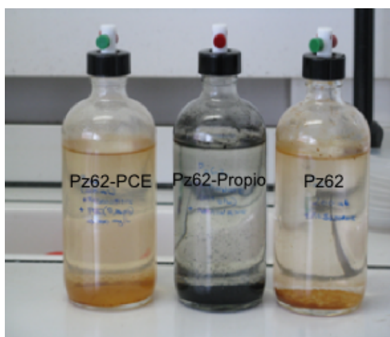
FIGURE 11.10 – Photographie illustrant la précipitation du sulfure de fer dans le microcosme Pz62-Propio
