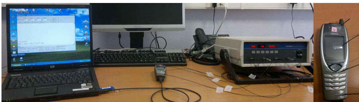
Figure 27. Mesure de la température à la surface des téléphones 'sham' et 'réel' par Luxtron.
