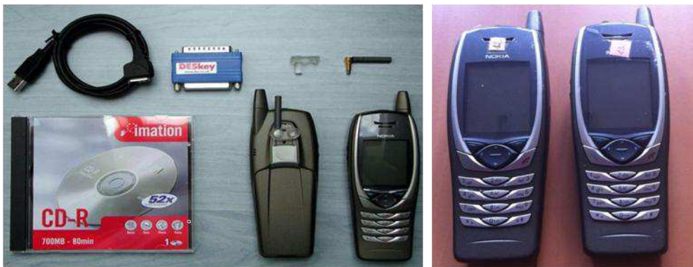
Figure 16. Les deux téléphones 'sham' et 'réel' utilisés dans l'étude. Ils ont exactement la même forme externe afin de réaliser les deux sessions expérimentales en double aveugle.
