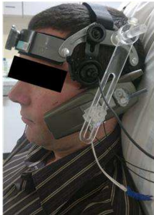
Figure 17. Position du téléphone pendant l'expérimentation selon les normes de CENELEC EN 50361. Le téléphone a été attaché au casque de support en plastique pour empêcher d'éventuelles interférences qui pourront se produire entre le métal et les ultrasons d'une part et les radiofréquences d'autre part.
