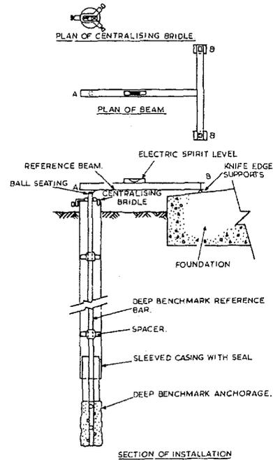
Figure 10 : Système de mesure d'enfoncement d'une fondation
