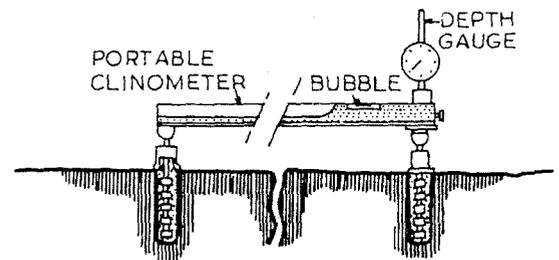
Figure 5 : Clinomètre portable, [4]
