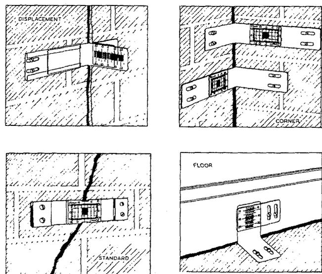
Figure 6 : Systèmes de mesure d'écartement de type "Vernier", [4]
