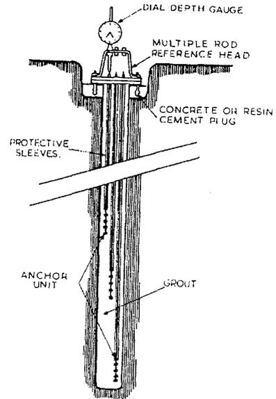
Figure 9 : Extensomètre multipoints
