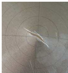
FIG. 10 – plaque de 0.5 mm en alu 5754, déflagration à 0.6 bar
