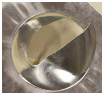
FIG. 9 – plaque de 1 mm en alu 2017, détonation à 0.6 bar
