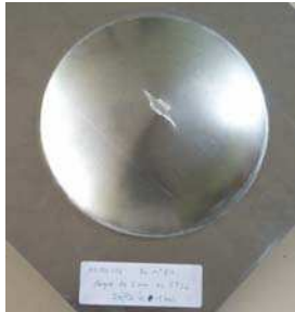
FIG. 6 – plaque de 2 mm en alu 5754, déflagration à 1 bar
