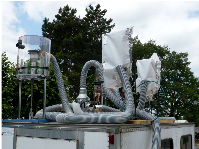
Figure 3 : Photos du système de dilution et de distribution de l'aérosol
