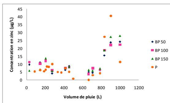
**Figure 5 - Courbe de percée du zinc en lysimètre**
