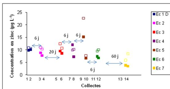
**Figure 6 - Courbe de percée du zinc en mini-lysimètre**
