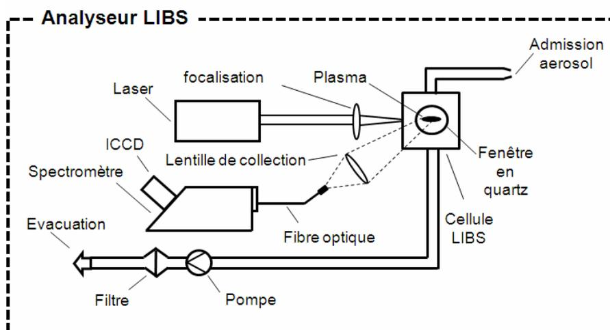
Figure 1 Schéma de principe du dispositif d'analyse LIBS
