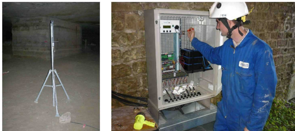
Fig. 2 : Sonde microphonique installée sur un trépied (à gauche) et unité d'acquisition (à droite).
