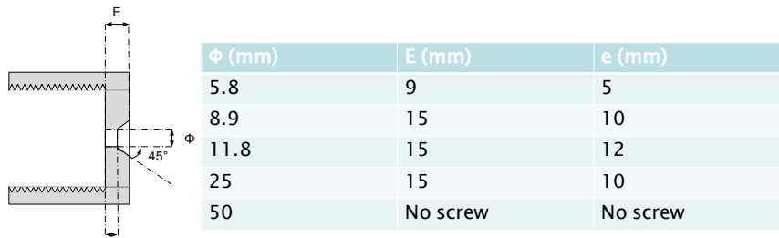
Figure 2 : Dimensions des orifices de fuite.
