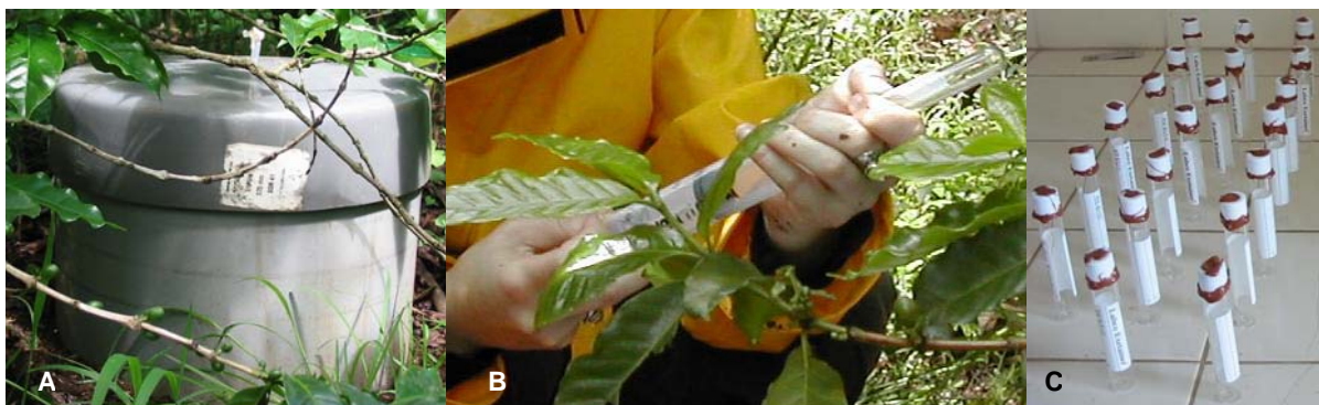
Figure I.10 Enceinte fermée placée au champ (A), injection d'un échantillon de gaz dans un tube (B) et tubes contenant les échantillons de gaz scellés pour transport au laboratoire
