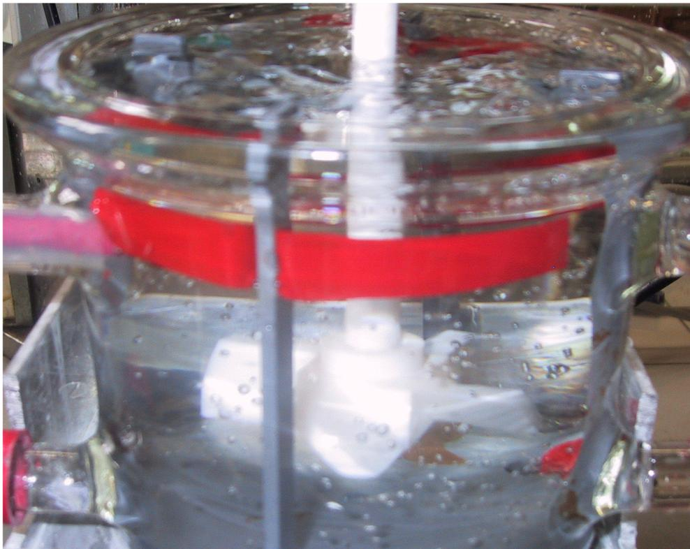
**Photo III-4 : Répartition des bulles dans le réacteur en présence d'agitation**
