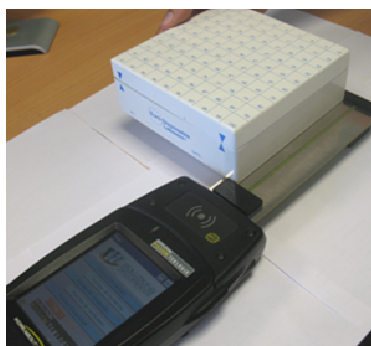
FIGURE 3.4 – Antenne d’inventoriage assisté des boîtes de cryotubes. (Credit : Psion Teklogix)
