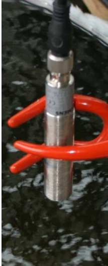
Figure 32: Capteur de niveau Siemens M18
