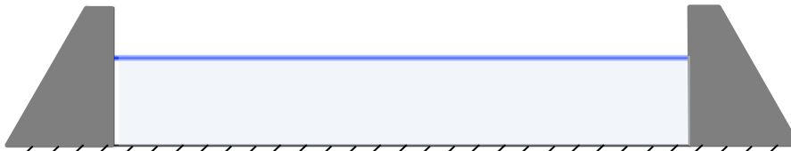
Figure 4: Existence d'une marche entre la surface de la nappe et la cuvette de rétention
