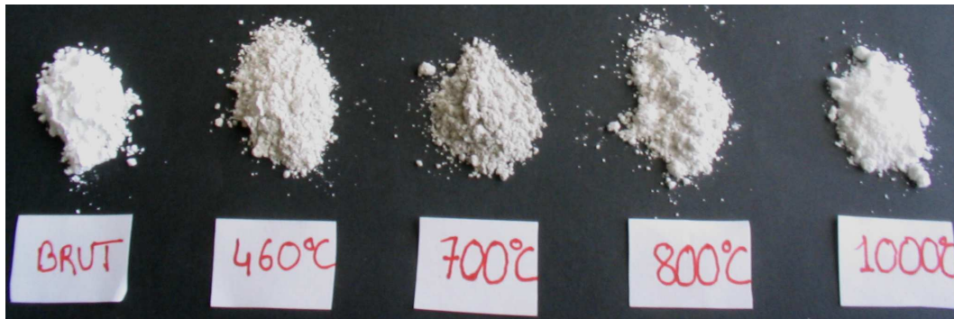
Figure C-12 : poudres traitées thermiquement
