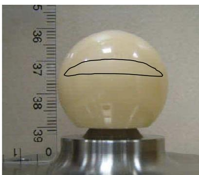
Figure 5. Tête testée à sec. En noir, les limites de la bande d'usure.
