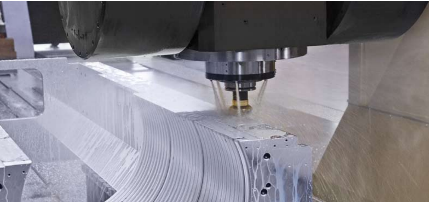
Erprobung von Kühlschmierstoffen
