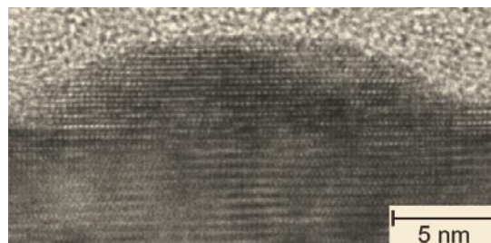
Querschnitt durch einen InGaN-Quantenpunkt. Im dunklen Teil des Bildes sind einzelne Atomreihen zu erkennen (Bild von A. Pretorius).
