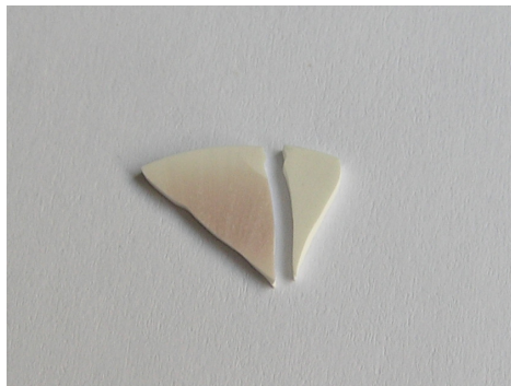
Abbildung 6.12: Oberflächenmodifikation bei ZrO_2 . Das rechte Bruchstück wurde wärmebehandelt, das linke dagegen nicht.
