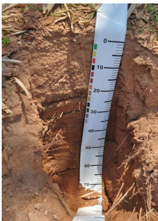
Figura 11: Perfil A.4 - Antropossolo 4. Esse perfil foi aberto em ambiente confinado. É possível identificar a presença de dois processos distintos de acumulação. O primeiro (marcado abaixo de 20cm) é resquício da antiga bacia de decantação e o segundo é resultado do atual processo erosivo e deposicional instalado após abandono da atividade minerária. É possível identificar a presença de raízes nas camadas inferiores, processo iniciado a partir de 20cm.
