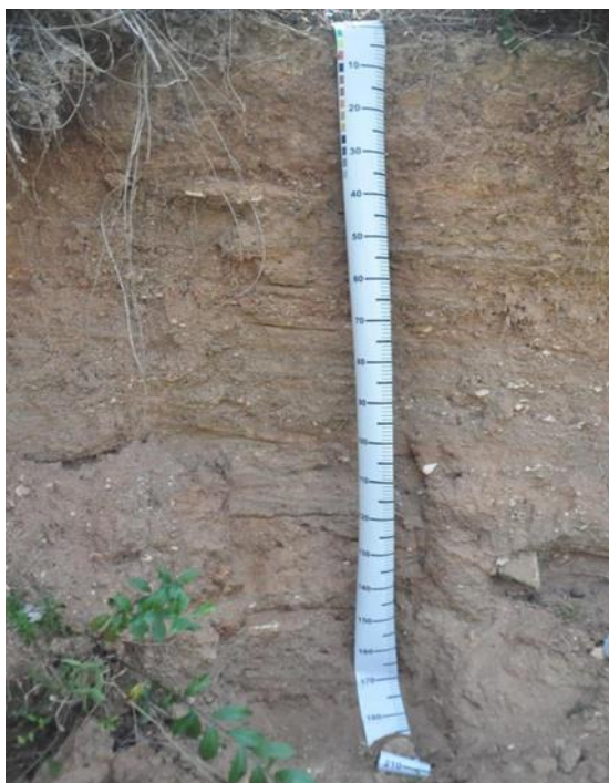
Figura 7: Perfil A.2 - Antropossolo 2. O perfil foi aberto entre o terraço fluvial e o leito menor. É possível identificar a presença de raízes e camadas distintas de deposição, além de grãos de rochas e minerais de diferentes tamanhos, além de apresentar sinais de gleização a partir de 145cm.
