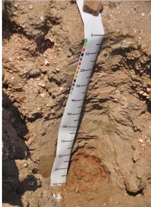
Figura 13: Perfil A.5 - Antropossolo 5. Esse perfil apresentou a incorporação de material sobre um horizonte natural que foi decapitado e não apresentou a disposição original. É possível identificar também a presença de grãos de minerais e rochas de diferentes tamanhos, indicando que o material foi apenas descartado ali.
