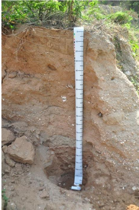
Figura 5: Perfil A.1 - Antropossolo 1. Pode-se perceber nesse perfil a presença de diferentes tamanhos de grãos de minerais e rochas, não há estrutura presente e é possível identificar as diferentes camadas de deposição e a presença de gleização na camada inferior.
