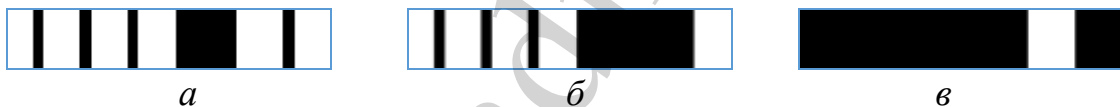
Рис. 18. Шаблиони пошуку (номерний знак типу рис. 2, сигнатура "8888 A8"): a – загальний T ; b – цифровий T_8 ; v – літерний T_A
