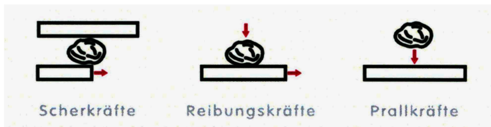
Abbildung 6.23: Mögliche Mahlkräfte in einer Luft-Gegenstrahlmühle (Fa. Noll)
