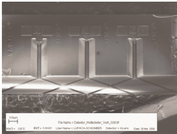
Fig.57 REM-Aufnahme der Sägeschnitte für die Ausbildung der Gräben, die zur Aufnahme der Glasfaser dienen.
