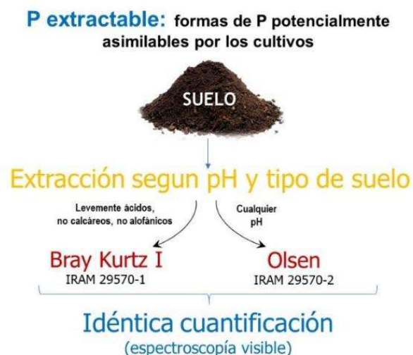
Figura 3: Los métodos de determinación de P extractable en suelos que están normalizados en Argentina difieren en su etapa de extracción, la cual debe seleccionarse en función del pH y del tipo de suelo, pero se asemejan en la etapa de cuantificación.
