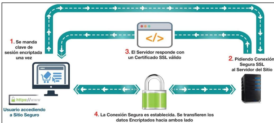
**Figura 3:** Funcionamiento de los certificados de seguridad SSL[19]
