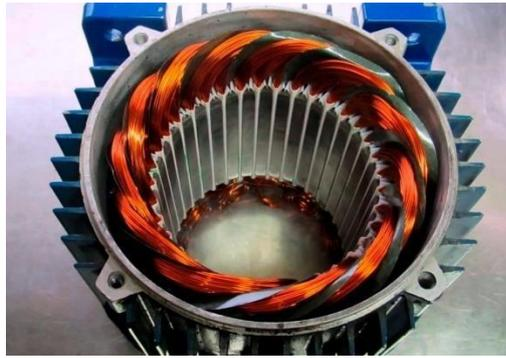
**Figura 4:** Partes de motor de inducción - Devanados de Estator. [7]
