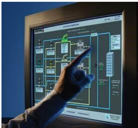
Figura 3. 21. Panel de operador Táctil [34].
