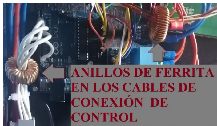
Figura 5.8. Disposición de los anillos de ferrita.
