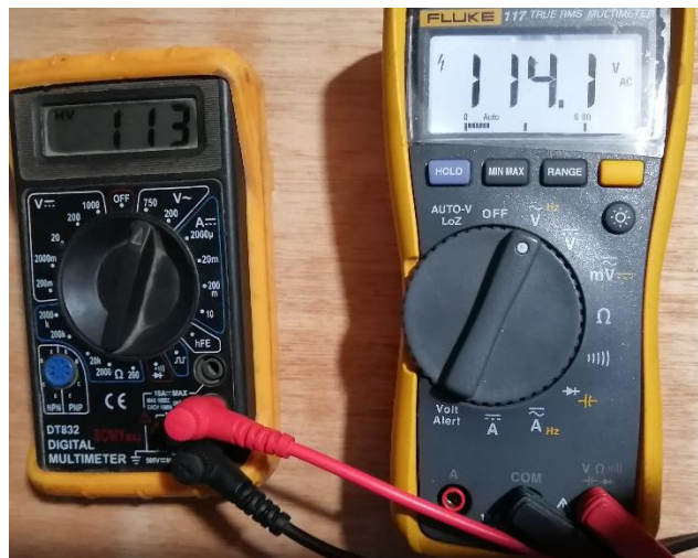
Figura U.1. Valores de voltaje de entrada y salida obtenidos con los voltímetros.
