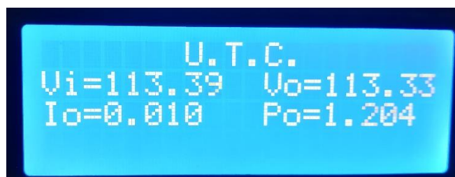
Figura U.2. Valores de voltaje de entrada, salida, corriente y potencia de salida en el prototipo.
