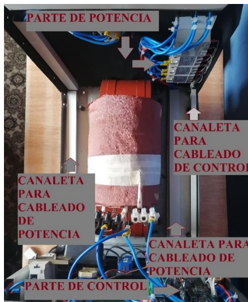
Figura 5.1. Ubicación de los elementos de la parte de potencia y control.
