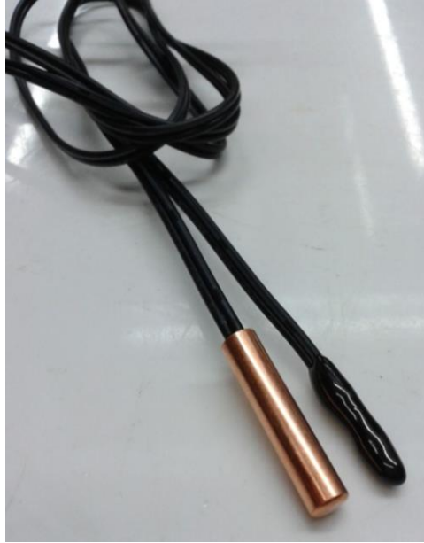
Imagen 22 Sensores de control para frio y humedad electrónicamente Fuente: Giler Henry (2021)
