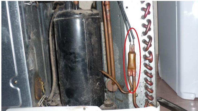
Figura 16. Sistema de expansión tipo capilar Fuente: Giler Henry (2021)
