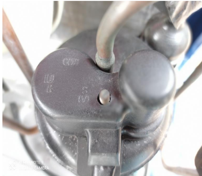
Imagen 25 Posición del motor compresor y señalización de su conexión Fuente: Giler Henry (2021)
