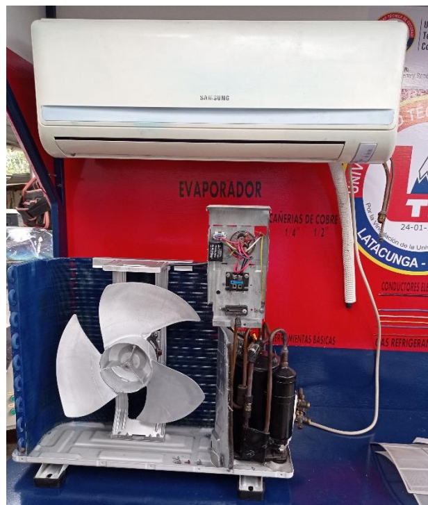
Imagen 13 Evaporador y condensador del tipo split en el banco para pruebas Fuente: Giler Henry (2021)
