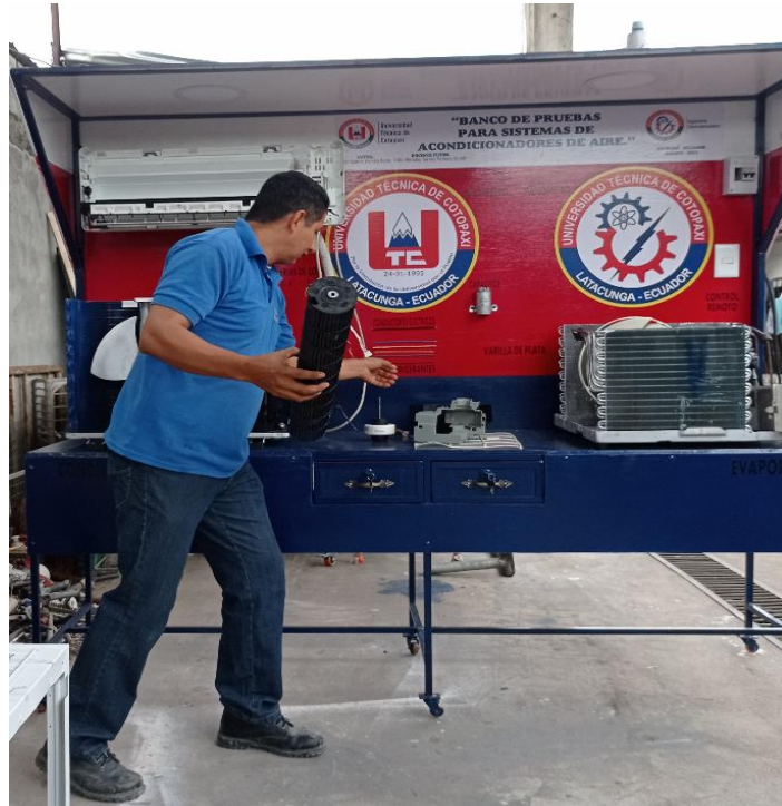
Imagen 10 Desmotando turbina del acondicionador tipo Split Fuente: Giler Henry (2021)
