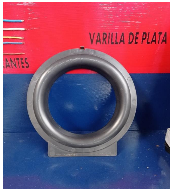
Imagen 28 Protector para la turbina del ventilador dispuesto en el acondicionador de aire tipo ventana
