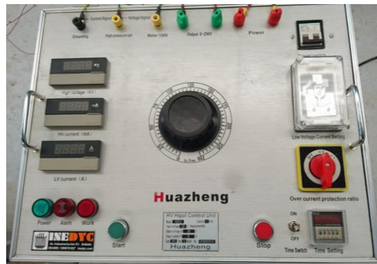
Figura 5.6. Caja mando del transformador.
