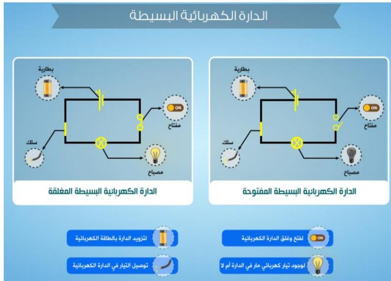
شكل (2): انفوجرافيك يوضح مفاهيم الدارة الكهربائية البسيطة.
