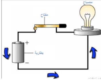
13. الشكل التالي يدل على الدارة الكهربائية
