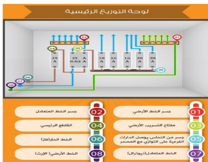
شكل (5): انفوجرافيك يوضح مفاهيم توصيل وتركيب لوحة التوزيع الرئيسية الكهربائية.
