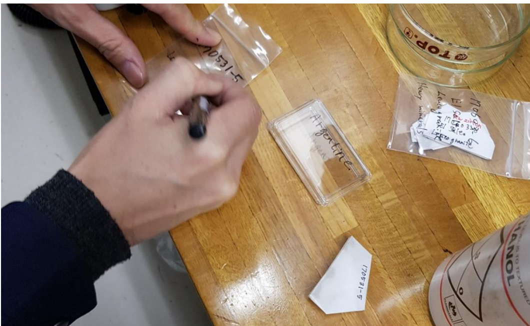
Figura 5.8. Almacenamiento y rotulado de la fracción pesada no-magnética
