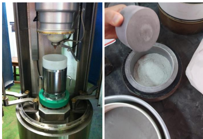
Figura 5.5. Recintos de muestra en diferentes equipos de conminución. Izq: Sample holder para 1 kg de muestra en el equipo SELFRAG Lab, conminución a ultra alto voltaje (90 – 200 kV). Der: Cazoleta de un molino Herzog, Vibrating simple mil
