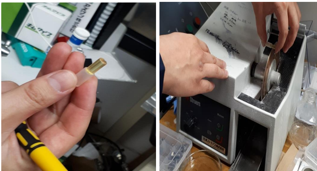
Figura 5.12. Pastilla extraída del tubo una vez pasado el tiempo de solidificación de la misma y posterior corte llevándola al espesor requerido por el equipo de datación.
