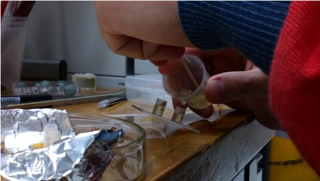
Figura 5.10. Vertido de la mezcla resina epoxi dentro de los moldes de polipropileno.
