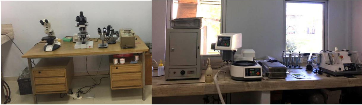
Figura 1.2. Laboratorio de preparación de muestras del SEGECRON. En la fotografía de la izquierda se muestra el escritorio preparado para el picking y análisis de cortes delgados. En la derecha la mesada con la estufa de secado y equipos para realizar cortes delgados.
