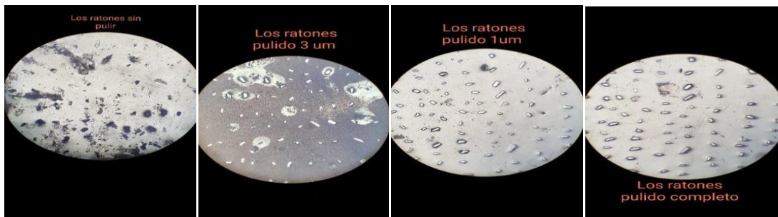
Figura 5.12. Fotomicrografías con luz reflejada, sin analizador, de distintas etapas durante el pulido de las pastillas de resina epoxi. De izquierda a derecha las imágenes corresponden a pulidos con pastas de 6, 3, 1,5 y 1 \mu\text{m} , respectivamente.
