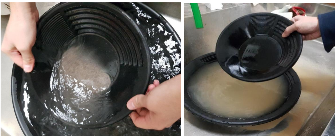
Figura 5.6. Distintos momentos durante el bateo. Izquierda: zarandeo inicial. Derecha: última etapa de lavaje lento.
