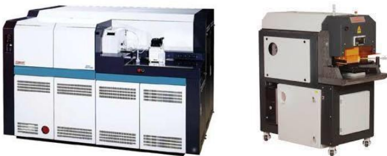
Figura 1.3. ICP-MS multicolector Neptune Plus. Figura y equipo de ablación láser Analyte G2 de Teledyne.
