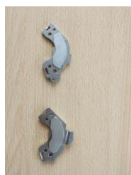
Figura 5: Imanes de Nd utilizados para la separación magnética.
