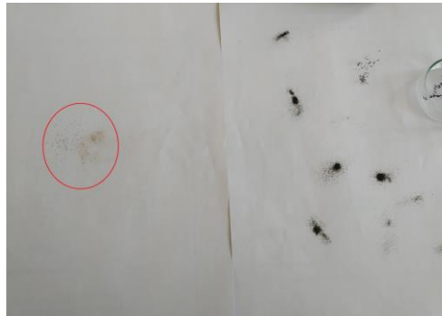
Figura 6: Resultado del proceso de la separación magnética, a la derecha se observan los granos paramagnéticos que fueron retirados de la muestra en varios pasos, a la izquierda (dentro del círculo rojo) se ve la fracción diamagnética que resulta ser de un color más claro.
