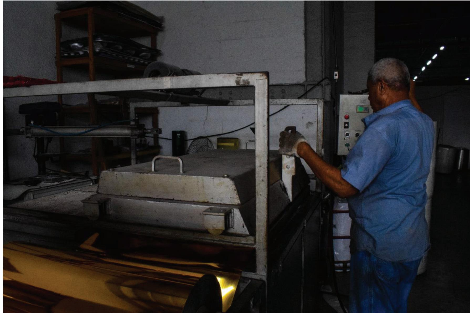
A técnica de *vacuum forming* exige o controle preciso da temperatura principalmente nas etapas de aquecimento e esfriamento.
