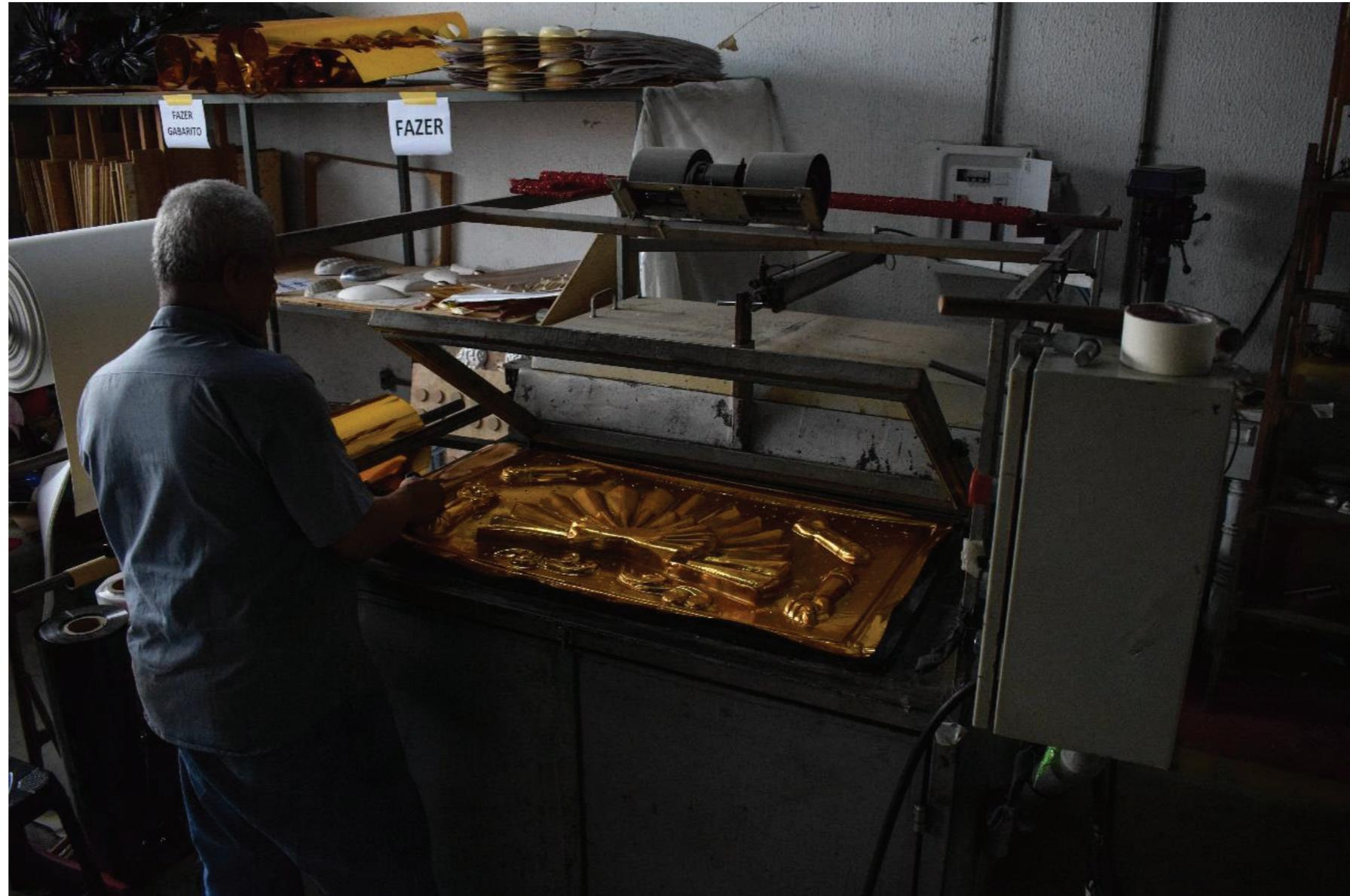
Ao longo de um dia de trabalho, dezenas de placas são batidas a vácuo em altíssima temperatura, produzindo de maneira imediata e serial peças escultóricas de pequena escala.
