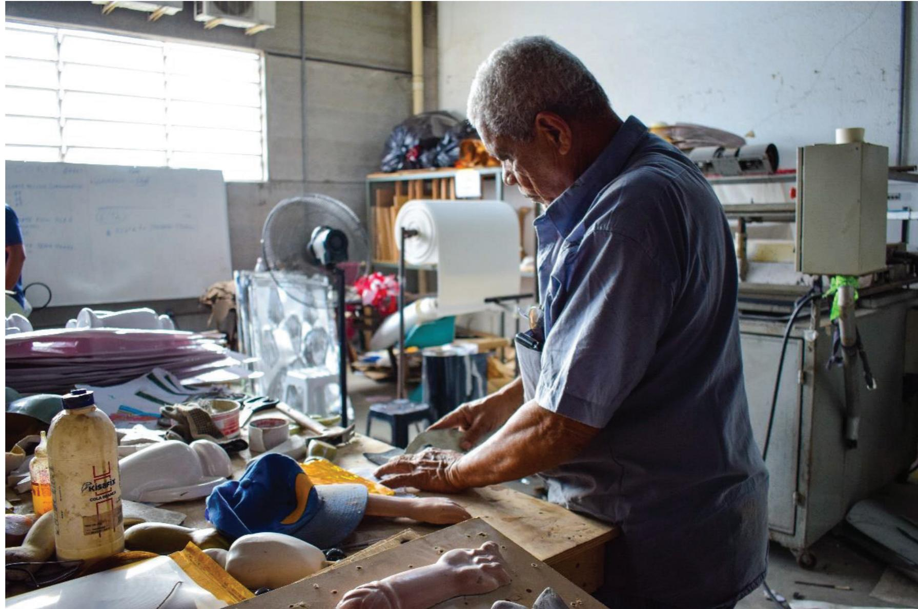
Antes de ser levado à máquina, o molde é lixado e polido para que a reprodução na placa não tenha deformações.
