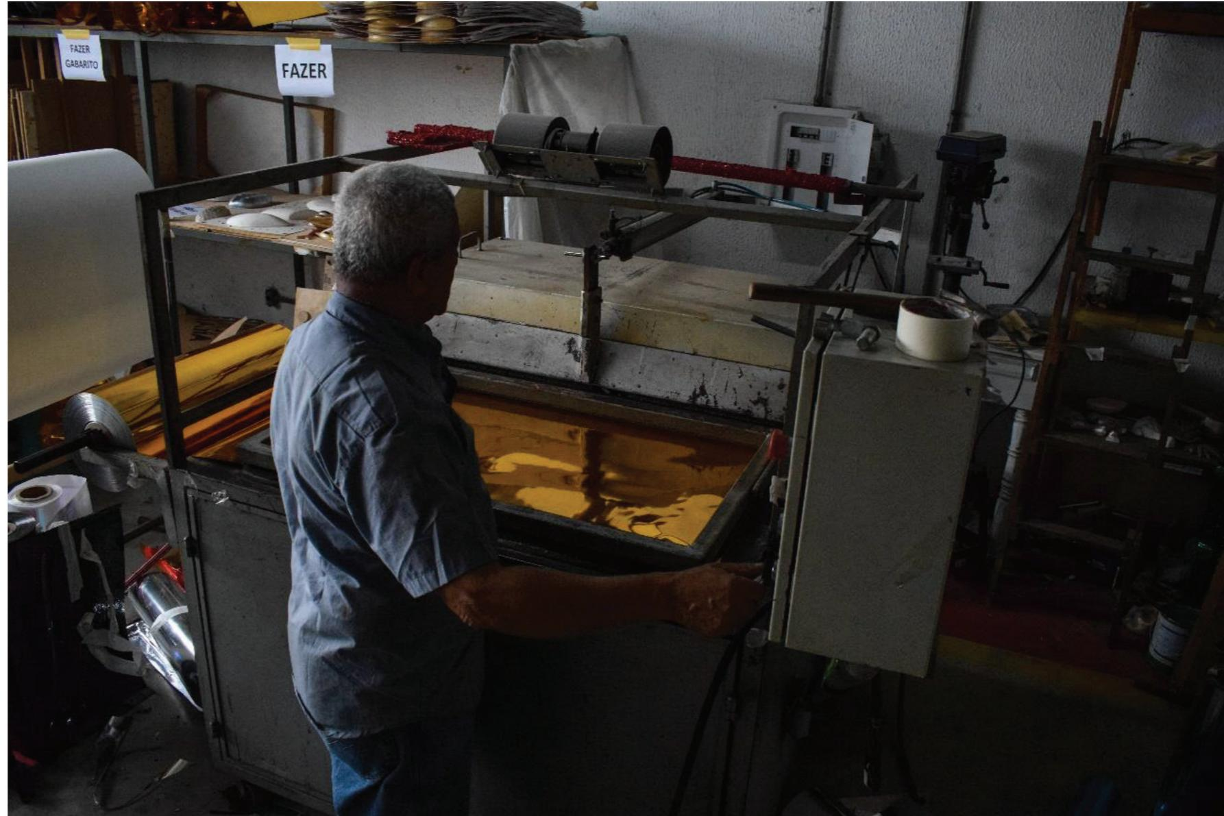
A partir de uma bobina laminada, o acetato é esticado e deve permanecer suficientemente tenso na moldura.
