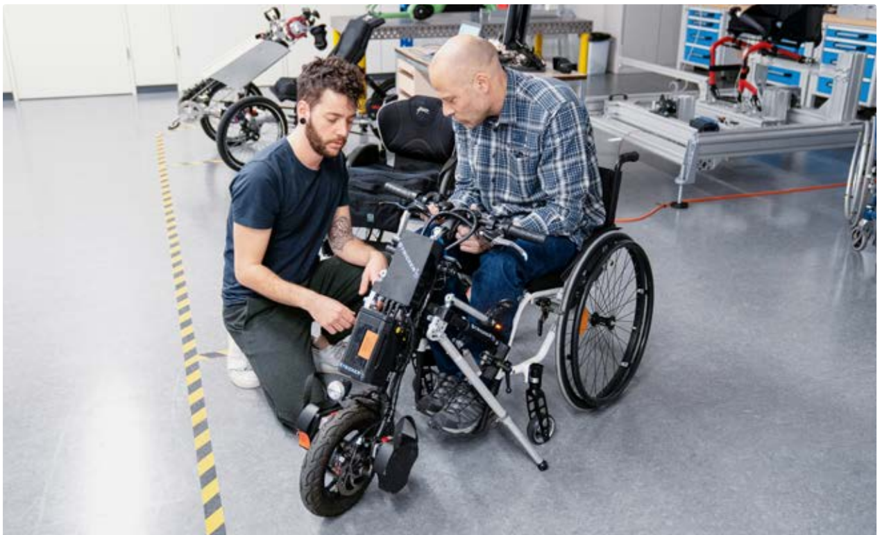
Tests de système de traction électrique pour fauteuil roulant
