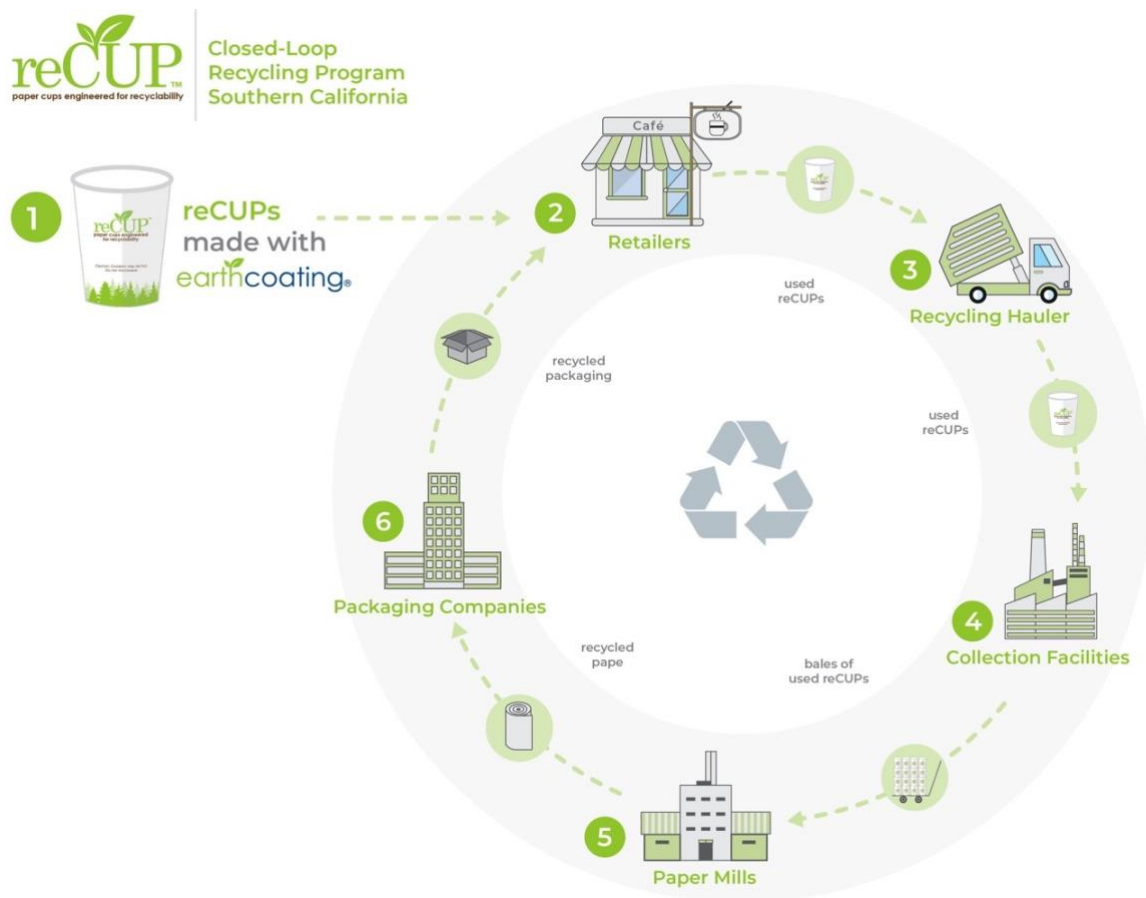
Figura 23 - Iniciativa de reciclagem da reCUP ® para os copos de papel reCUPs produzidos com EarthCoating ® - resina mineralizada que se fragmenta, permitindo a separação dos materiais e reciclagem da fibra. (fonte:reCUP ® )
