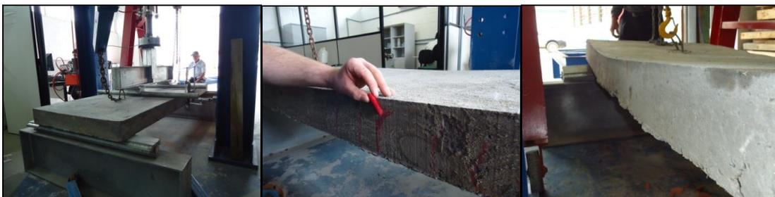
Figura 5: Posicionamento do protótipo de laje. (b) Marcação das aberturas de fissuras (c) Configuração do protótipo de laje após ruptura.
