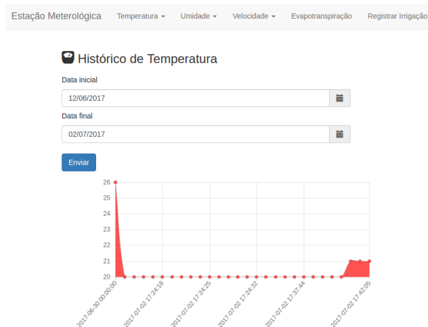
Figura 4. Gráfico de temperatura gerado pelo software desenvolvido
