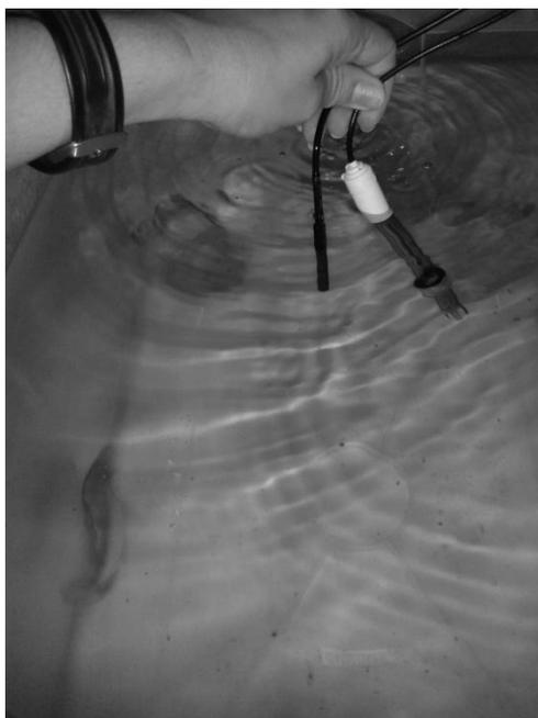
**Figura 4. Testes dos sensores de temperatura e pH em aquário experimental**
