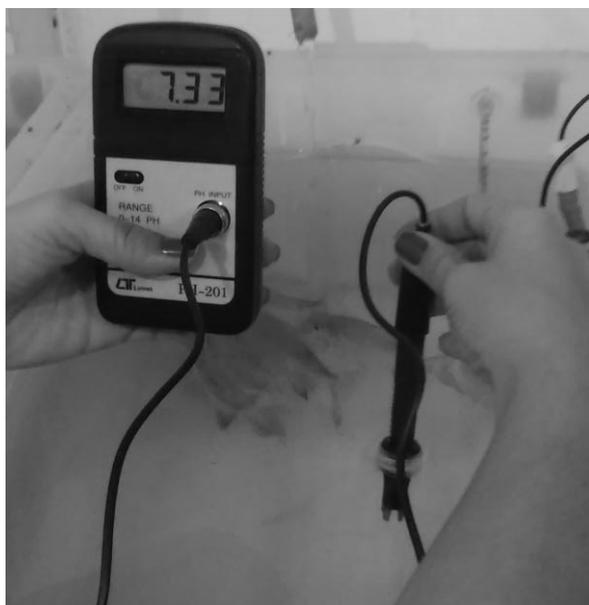
**Figura 6. Análise de pH utilizando peagâmetro portátil modelo PH-201, em aquário experimental.**
