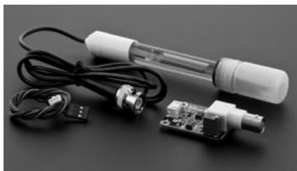
Figura 2. Sensor e módulo para pH
