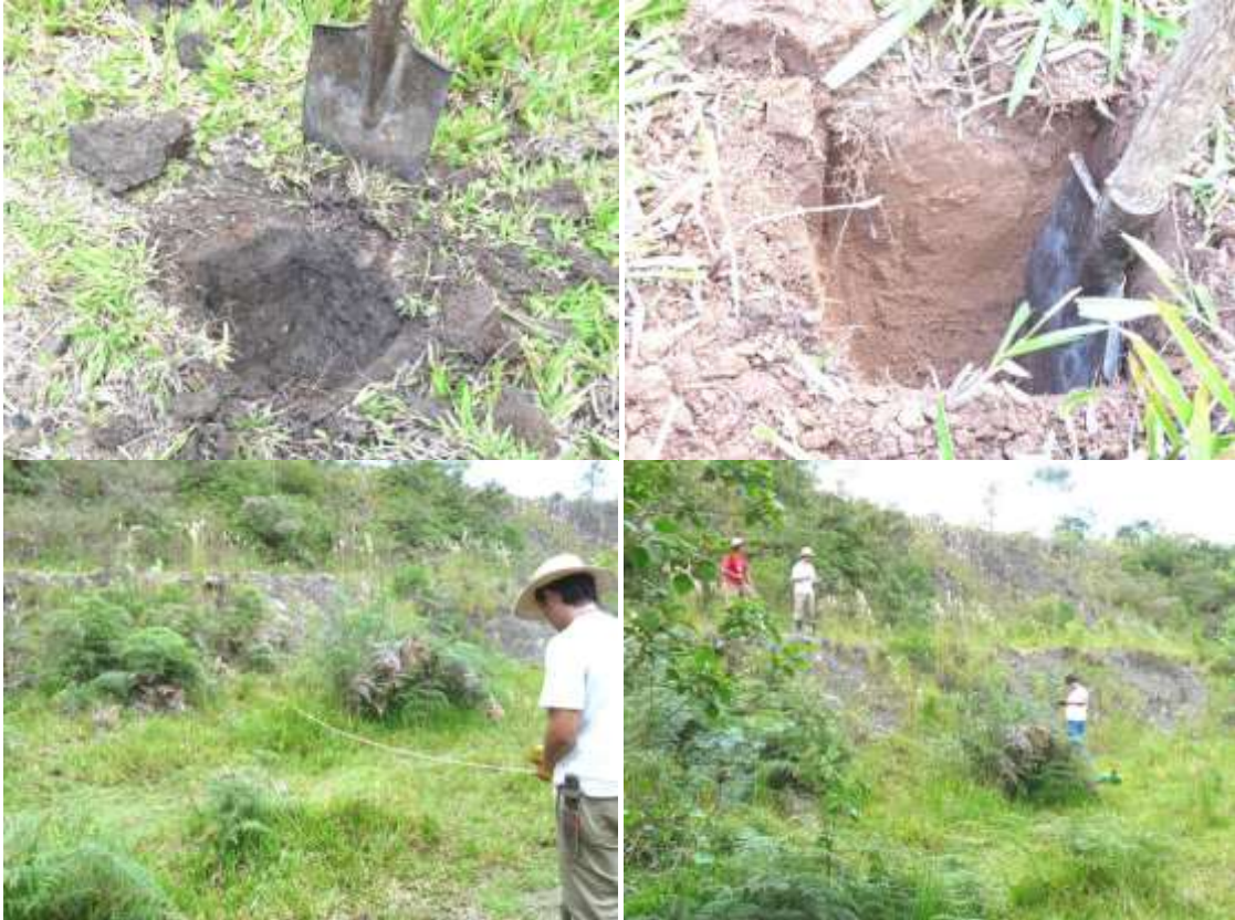
Figura 5: Pontos levantados na área de estudo; A) Sondagem com presença de rejeito; B) Sondagem com presença de solo; C) Medida da influência do depósito com a área entorno; D) Levantamento da área pela equipe.
