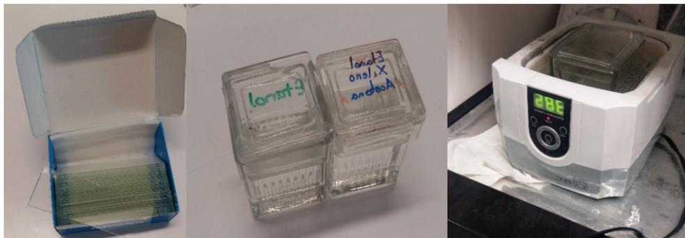
**Figura 2.** Componentes para limpieza de sustratos, a) sustratos de vidrio, b) reactivos químicos y c) equipo de limpieza ultrasónico
