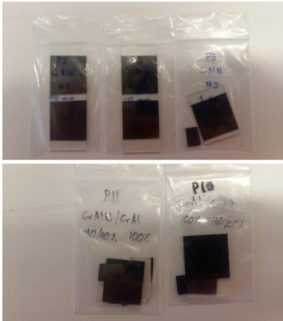
Figura 5. Sustratos de vidrio con depósitos de bicapas CrAlN/CrAl
