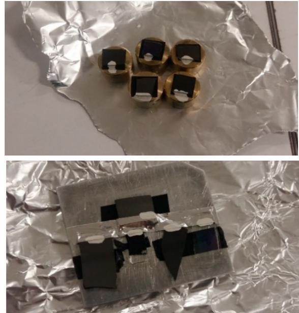
Figura 6. Muestras para realizar el análisis en el SEM (1) y EDS (2)
