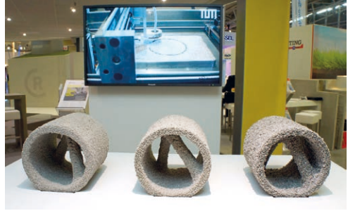
Bild 9: Demonstratoren auf der BAU 2017, hergestellt mit dem Verfahren des selektiven Zementleimeintrags | Fig. 9: Demonstrators at BAU 2017, produced with the selective cement paste application method
