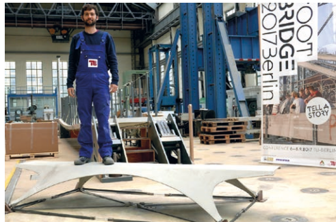
Bild 11: Carbonbeton-Schalendemonstrator mit Regelflächengeometrie, gezeigt auf der Footbridge 2017 Conference | Fig. 11: Carbon reinforced concrete shell demonstrator with ruled surface geometry, exhibited at the Footbridge 2017 Conference
