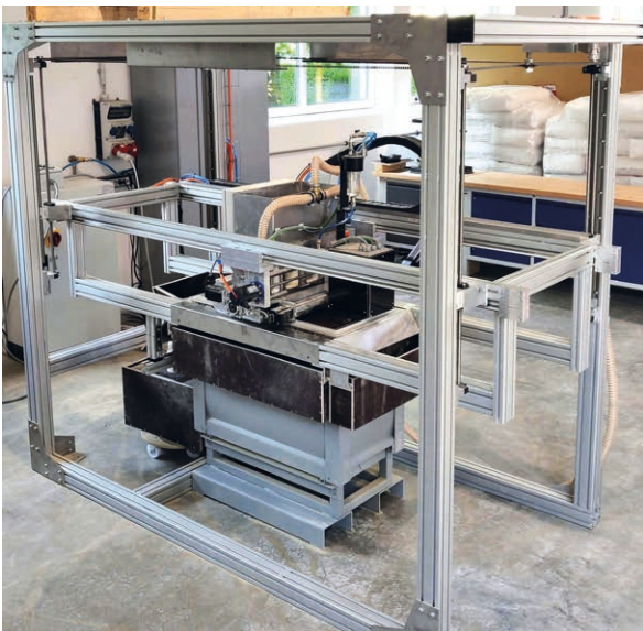
Bild 1: Versuchsdrucker V2 (links) und im Gerät gefertigtes Wandelement (rechts) | Fig. 1: Experimental 3D printer V2 (left) and wall element fabricated with the device (right) | Source: Daniel Talke, Klaudius Henke
