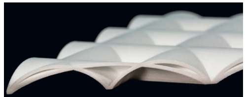
Bild 4: Idee für die innere Auflösung flächiger Bauteile mittels Schalenstrukturen | Fig. 4: Idea for the internal weight reduction of cross sections of planar components by shells structures | Photo: Sylke Scholz, Dresden
