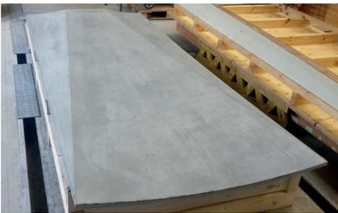
**Bild 5:** Unterseite eines Carbonbeton-Halbfertigteils für ein Randfeld | **Fig. 5:** Underside of a carbon reinforced concrete semi-precast part for a side span | Source: Marc Koschemann
