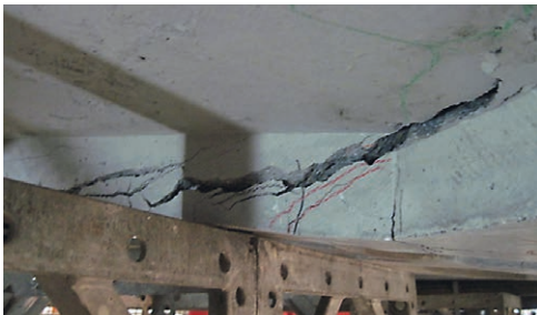
Bild 8: Versagen durch Schubrissbildung
