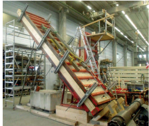
Bild 14: Versuchsstand für Betonierversuche; im Vordergrund geneigtes Schalungssystem, im Hintergrund lotrechtes Schalungssystem | Fig. 14: Test set-up for concreting tests; front: inclined formwork system, background: vertical formwork system
