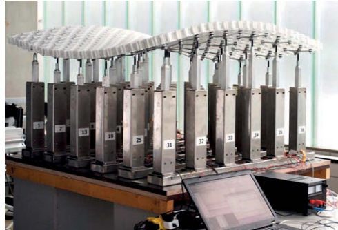
Bild 10: Funktioneller Modellversuch mit adaptiver Stützfläche im Maßstab 1 : 2,5 und aktiv steuerbaren Aktuatoren | Fig. 10: Functional mock-up testing with adaptive support surface (scale 1 : 2.5) and actively controllable control elements
