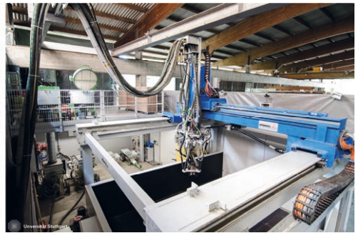
Bild 8: Gesamtkonzept und Realisierung der Plattform zur Herstellung funktional graderter Betonbauteile | Fig. 8: Concept and realization of the whole manufacturing system to produce graded concrete components
