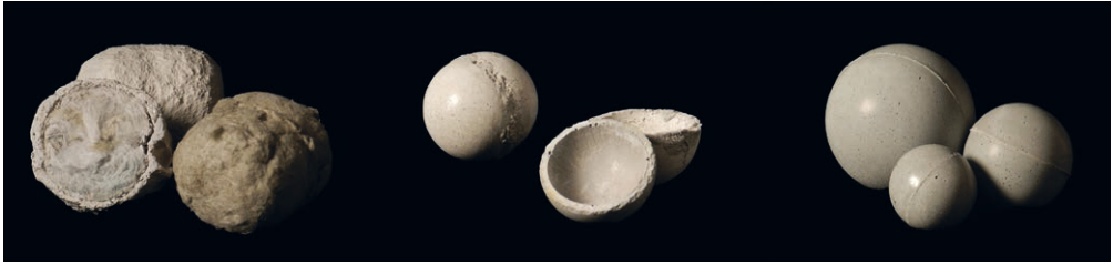
Bild 17: Prototypen von mineralischen Hohlkörpern, hergestellt (von links nach rechts) im Beschichtungs-, Press- und Rotationsverfahren | Fig. 17: Prototypes of concrete hollow spheres produced by coating, pressing and rotating (from left to right)
