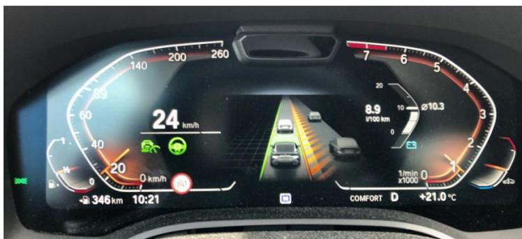
Abbildung 2.1.: Ansicht des Kombiinstruments mit Anzeigen der teilautomatisierten Assistenzfunktion. Die Aktiv-Zustände der Längs- und Querverführung sind als grüne Symbole links und die Animation des erfassten Umfelds sowie der aktuell gebildeten Rettungsgasse mittig dargestellt. Oberhalb der Animation befindet sich die integrierte Kamera zur Erfassung des Fahrerzustands.
