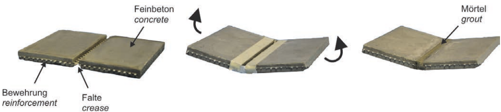
Bild 1: Fold-and-grout: Falten von Beton mit definierter Faltkante und nachträglichem Vermörteln [1] | Fig. 1: Fold-and-grout: folding of a concrete plate with a pre-defined crease and subsequent grouting
