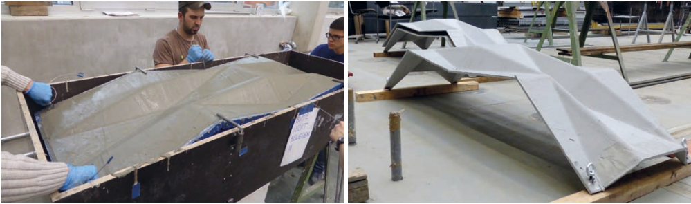
Bild 20: Gefalteter Träger mit Waterbomb-Faltpattern, links während der Faltung und rechts fertiger Träger | Fig. 20: Folded girder with waterbomb crease pattern: during folding (left) and finished girder (right)
