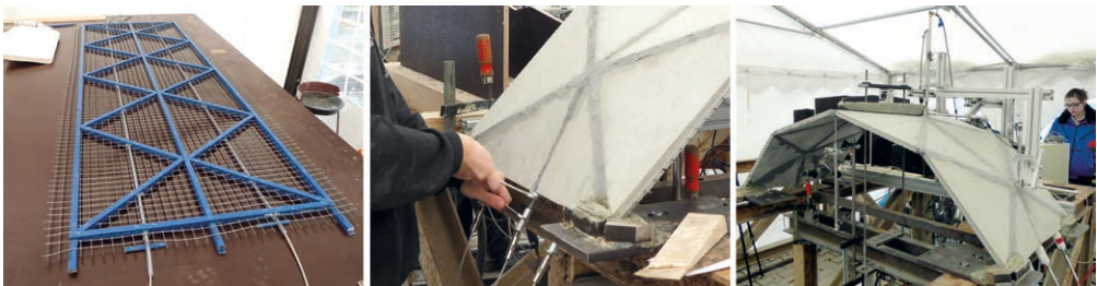
Bild 21: Vorgespannter gefalteter Bogen; v. l. n. r.: Faltpattern mit eingebauten Spanngliedern, Aufbringung der Vorspannung und experimentelle Untersuchung | Fig. 21: Prestressed folded vault; from left to right: crease pattern with installed tendons, applying the pre-stressing, testing of a vault
