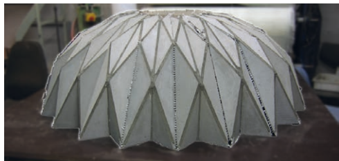
Bild 12: Kleinformatige Prototypen: erste Oricrete-Struktur (links) und Oridome, gefügt aus 20 Segmenten (rechts) | Fig. 12: Small scale prototypes: first oricrete structure (left) and 'Oridome' made out of 20 segments (right)
