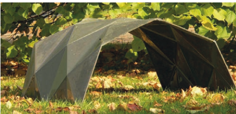
Bild 12: Kleinformatige Prototypen: erste Oricrete-Struktur (links) und Oridome, gefügt aus 20 Segmenten (rechts) | Fig. 12: Small scale prototypes: first oricrete structure (left) and 'Oridome' made out of 20 segments (right)
