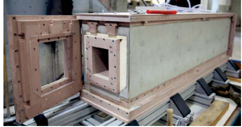
Bild 10: Gegossener Balken in der Schalung | Fig. 10: Cast beam in formwork
