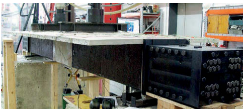
Bild 12: Versuchsaufbau; dargestellt ist der mit CF-Gelege verstärkte Plattenbalken PB2 | Fig. 12: Test setup; here: T-beam PB2 strengthened with CF-sheets
