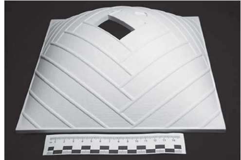
Bild 24: 3D-gedrucktes Gipsmodell des Schalentragerwerks | Fig. 24: 3D-printed plaster model of the shell structure
