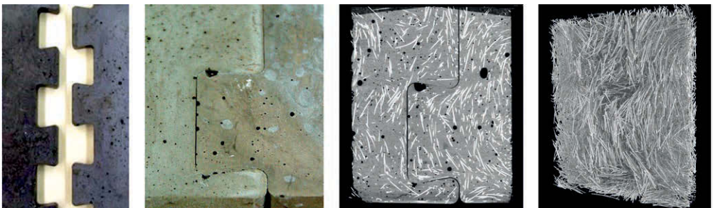
Bild 8: Flächige UHPFRC-Verbindung; v. l. n. r.: Proben mit Zähnen, Detail Verzahnung nach Fügen durch Zusammenpressen mit 5 kN, Prüfung auf Fehlstellen im CT mit erkennbarer Rissbildung im unteren linken Viertelzahn, visualisierte 3D-Faserverteilung des UHPFRC im Zahnbereich | Fig. 8: Flat UHPFRC connection; f.l.t.r.: test specimen with teeth, detail of toothing after joining by pressing together with 5 kN, check for defects via CT with visible crack formation in the lower left quarter of the tooth, visualized 3D fibre distribution of the UHPFRC in the tooth region
