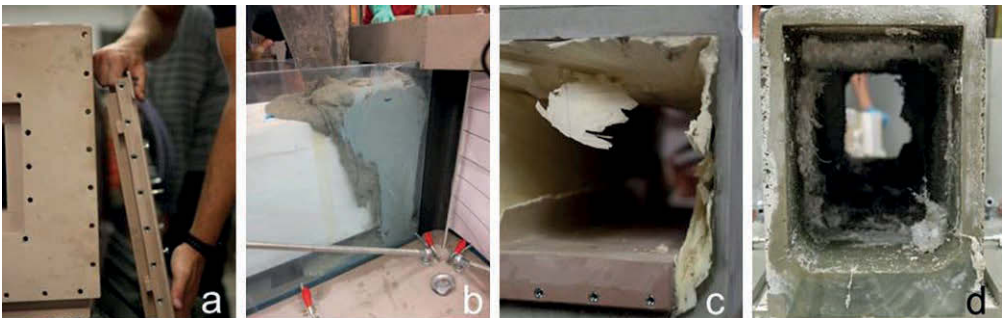
Bild 18: Wesentliche Verbesserungen an den Verbindungen zwischen den Komponenten der Schalung (a, b) und dem Kern (c, d) | Fig. 18: Main improvements concerning the connections between the components of the formwork (a, b) and the core (c, d)
