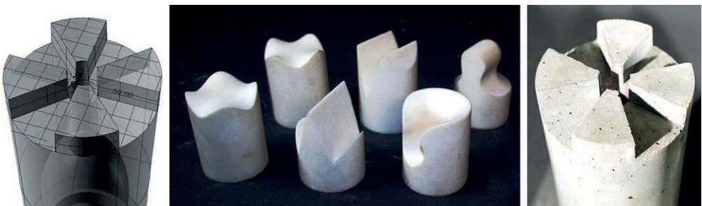
Bild 2: Realisierung von trocken gefügten Stoßverbindungen für rohrförmige Stäbe; links: 3D-Modell, Mitte: Überprüfen der digitalen Daten durch 3D-Gipsdrucke, rechts: UHPFRC-Probekörper | Fig. 2: Manufacturing of dry joints for tubular elements; left: 3D model; middle: verification of digital data by 3D plaster prints; right: produced UHPFRC specimen
