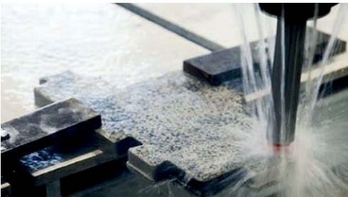
Bild 20: CNC-Fräsen (links) und Wasserstrahlschneiden von UHPFRC-Platten mit 30 mm Dicke (rechts) | Fig. 20: CNC milling (left) and waterjet cutting of UHPFRC-plates of 30 mm thickness (right)
