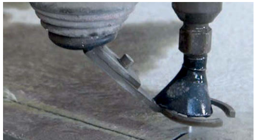
Bild 20: CNC-Fräsen (links) und Wasserstrahlschneiden von UHPFRC-Platten mit 30 mm Dicke (rechts) | Fig. 20: CNC milling (left) and waterjet cutting of UHPFRC-plates of 30 mm thickness (right)
